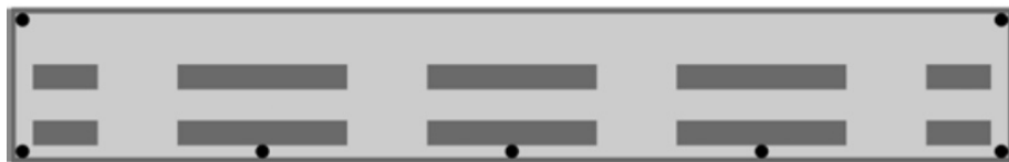
Рис. 9 Схема крепления стартовой полосы.
